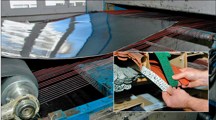
Bei farbigem Leder wird die Farbe via Druckmaschine auf das Leder aufgedruckt. (Bilder: Anita Neuenschwander)
